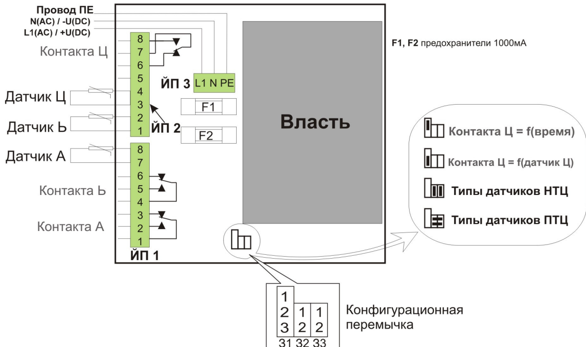
Рис. 2 – монтажная схема РТТ-4/2 и описание конфигурации соединителя.
