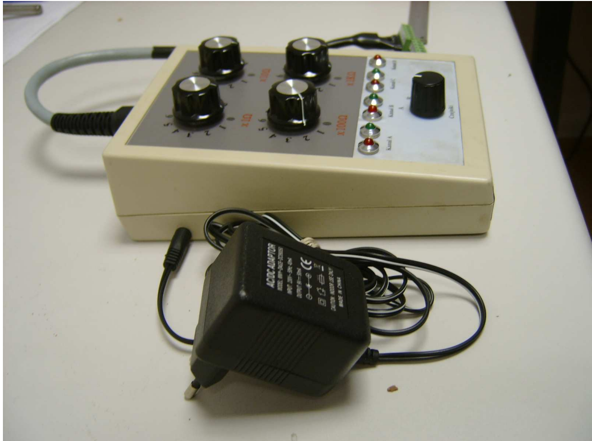
Rys.2 Podłączenie zasilacza do testera
