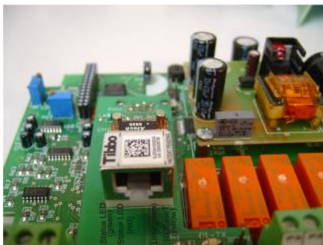
Rys. 6 – Płytkę rozszerzeń Ethernet – diody statusowe umieszczone pod gniazdem RJ45.
