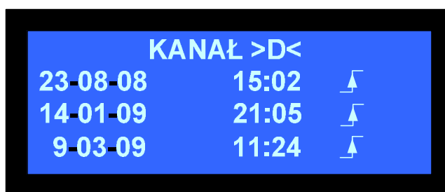
Ekran rejestracji przekroczeń temperatury (czujnik PTC)
