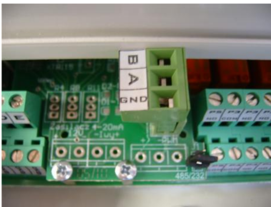
Rys. 15 – Płytkę rozszerzeń RS485
