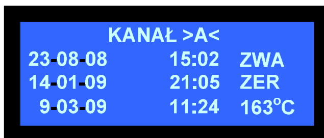
Ekran rejestracji przekroczeń temperatury (czujnik Pt100)
